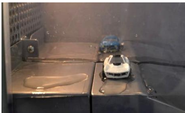
写真3 津波実験装置 青車：波浪 白車：津波
